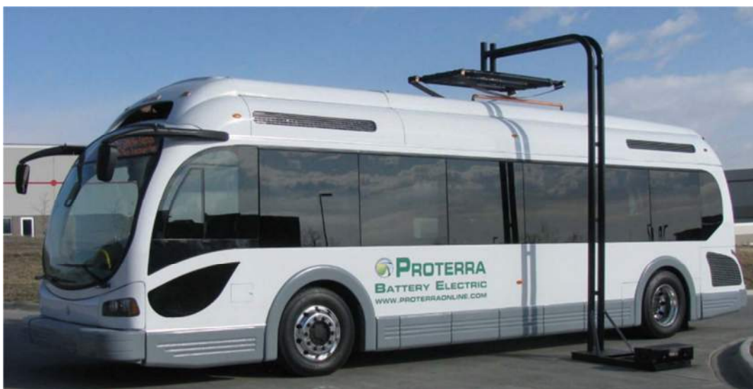
Imagen 16. Imagen de sistema de carga de prototipo de Protterra . Fuente: Jornadas auto eléctrico, Universidad de Cuyo, 2012
